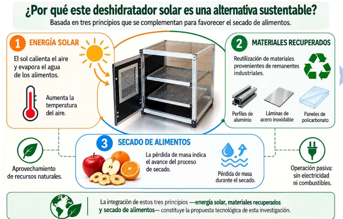
Figura 2. Relación entre la energía solar, la reutilización de materiales y el proceso de secado en el prototipo desarrollado.
