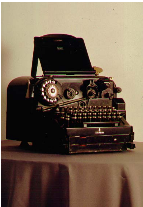
Figura 2. Teleimpresor T100, Siemens, utilizado entre los años 1960 y 1990.
