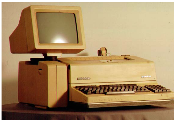
Figura 4. Teleimpresor T1000, marca Siemens, utilizado de 1970 a 1990..
