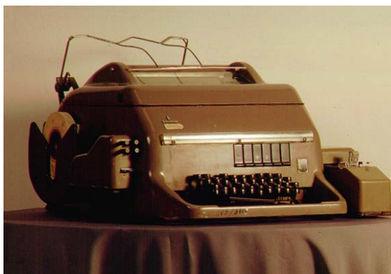
Figura 3. Perforador y transmisor de cinta Modelo T 68, utilizado a partir de 1960 hasta finales de 1990.
