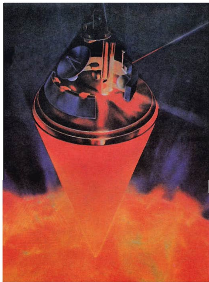
Figura 3. La "sonda (solar) estelar" concebida para estudiar las regiones inexploradas de la atmósfera solar donde el viento solar se vuelve supersónico (3 a 60 radios solares). Esta concepción artística pretende ilustrar el perihelio de la nave a aproximadamente 2.1 millones de km de la superficie solar.
