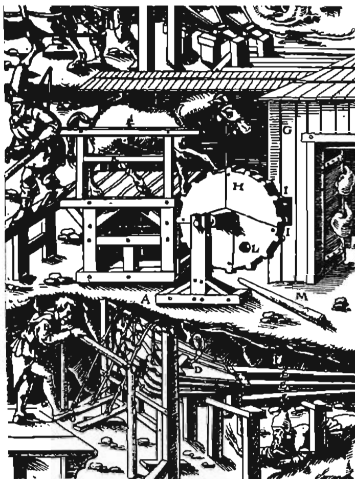
Máquina para introducir aire puro en las minas. Siglo XVI. G. Agrícola.
