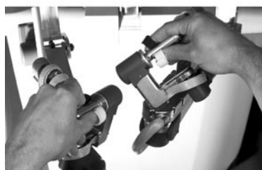
FIGURA 3. Se observa cómo el robot maestro-esclavo tipo Da Vinci traduce los movimientos de la mano del cirujano en movimientos del instrumental.
