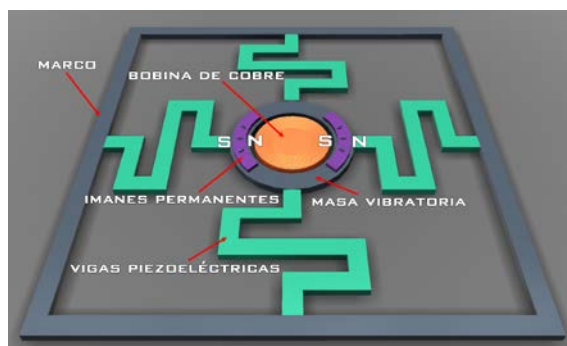
Figura 5. Microgenerador propuesto para obtener energía eléctrica del movimiento humano.
